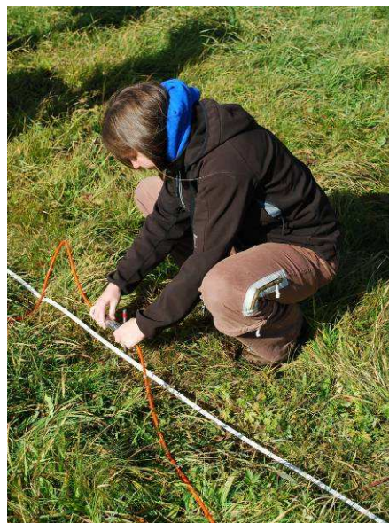
Geoelektrické měření in-situ
